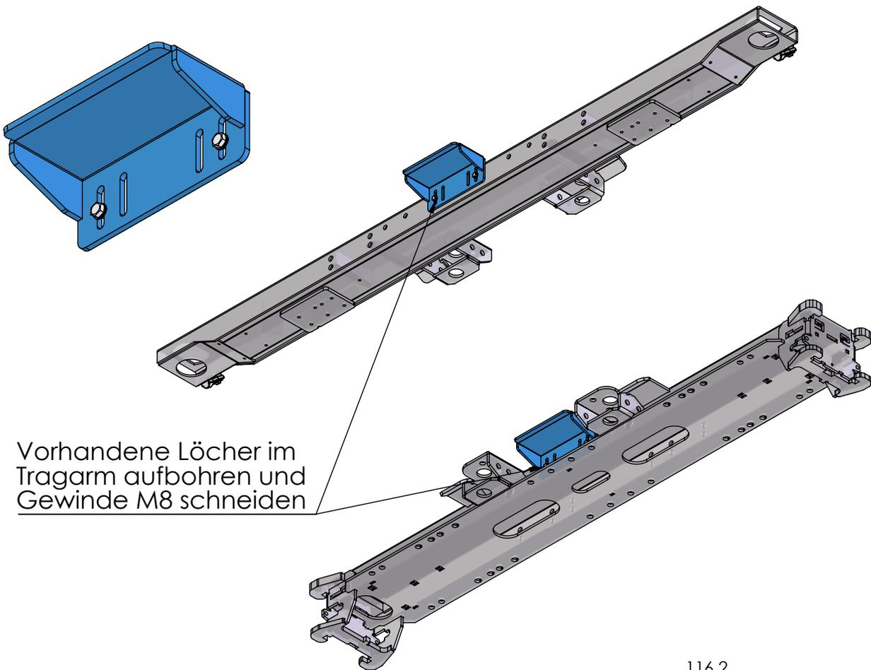
Vorhandene Löcher im Tragarm aufbohren und Gewinde M8 schneiden
